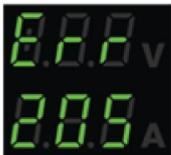
L'exemple présenté dans l'image de gauche indique un défaut de tension d'alimentation du générateur.
